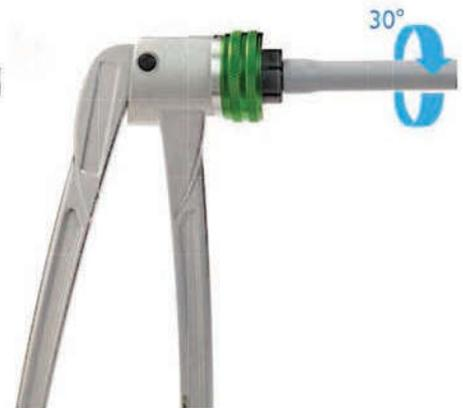
▲ Fig. 34: Expand STABIL pipe.
